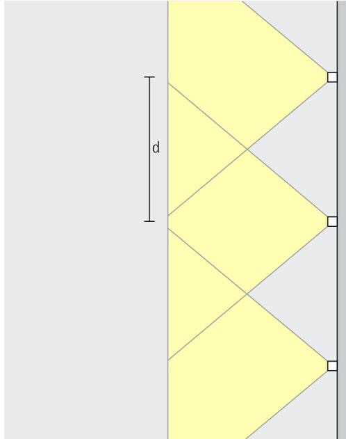
Für eine gleichmäßige Bodenflutung kann der Leuchtenabstand (d) das bis zu 2-fache der Montagehöhe (h) betragen. Wird die Leuchte zur optischen Führung eingesetzt, kann der Leuchtenabstand das bis zu 10-fache der Montagehöhe betragen.
