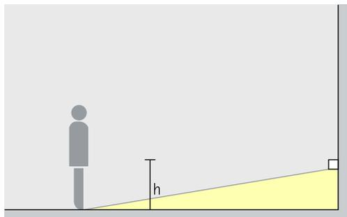
Mit einer tiefstrahlenden Lichtverteilung ermöglichen Kubus Bodenfluter eine dezente, blendfreie und gleichmäßige Beleuchtung von Freiflächen in Fassadennähe. Die empfohlene Montagehöhe (h) liegt bei 0,8 Metern über dem Boden.
