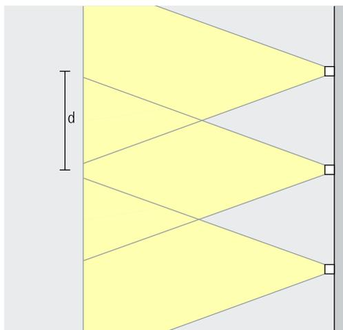
Für eine gleichmäßige Bodenflutung kann der Leuchtenabstand (d) das bis zu 2-fache der Montagehöhe (h) betragen. Wird die Leuchte zur optischen Führung eingesetzt, kann der Leuchtenabstand das bis zu 10-fache der Montagehöhe betragen.
