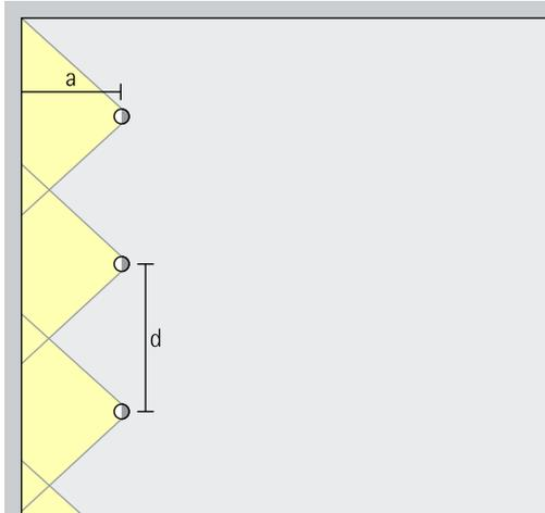
Pour une bonne homogénéité dans la longueur, l'entraxe (d) entre les projecteurs à faisceau mural à lentille Pantrac peut correspondre jusqu'à 1,5 fois la distance (a) au mur.
