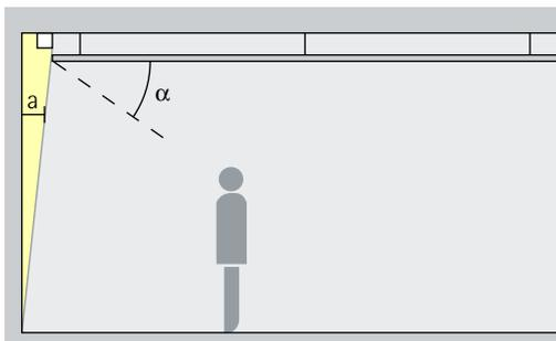
L'angolo di schermatura ( $\alpha$ ) dipende dalla posizione del controsoffitto o dalla grandezza della scanalatura di luce. Una piccola apertura tra la parete e la schermatura del controsoffitto riduce il cono di luce sul pavimento.
