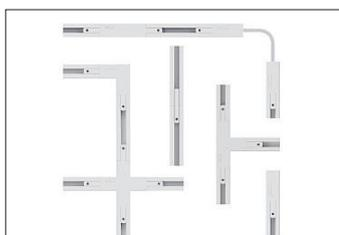
Suddividete i binari elettrificati in segmenti in funzione della lunghezza e della geometria. È altresì necessario osservare il carico elettrico massimo (vedi pag. 21). Definite l'alimentazione e i giunti necessari. In presenza di giunti a T dirimpettati è necessario inserire nel progetto un invertitore di polarità.
